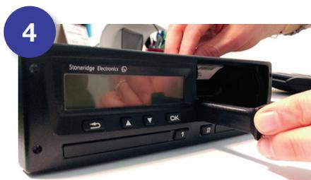
Inserire il cavo di scarico (in dotazione con il dispositivo) all'interno dell'apposito attacco sul tachigrafo digitale.
