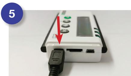
L'altra estremità inserirla al dispositivo D-Box 2. Il dispositivo si accende in automatico e apparirà la scritta **Premere un bottone**.
