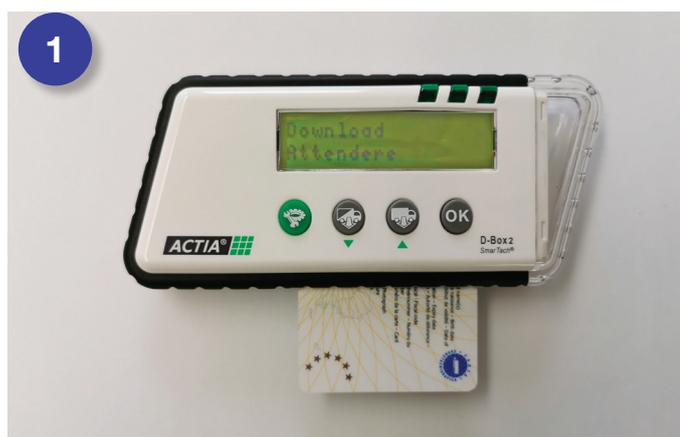
**Inserire la scheda del conducente** nella fessura del dispositivo come mostrato in figura.
