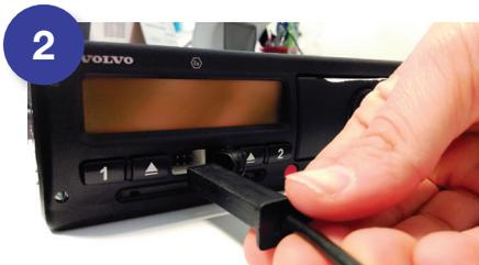
Successivamente inserire il cavo di scarico all'interno dell'apposito attacco sul tachigrafo digitale.
