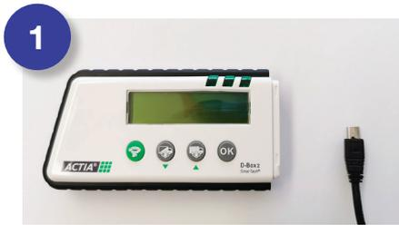
Collegare il cavo USB a lato del dispositivo D-Box 2 come mostrato in figura.
