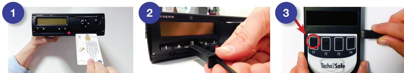
Inserire la **carta dell'azienda** nel tachigrafo e successivamente inserire il cavo di scarico (in dotazione con il dispositivo) all'interno dell'apposito attacco sul tachigrafo digitale. L'altra estremità inserirla al dispositivo Tacho2Safe. Il dispositivo si accende in automatico.
