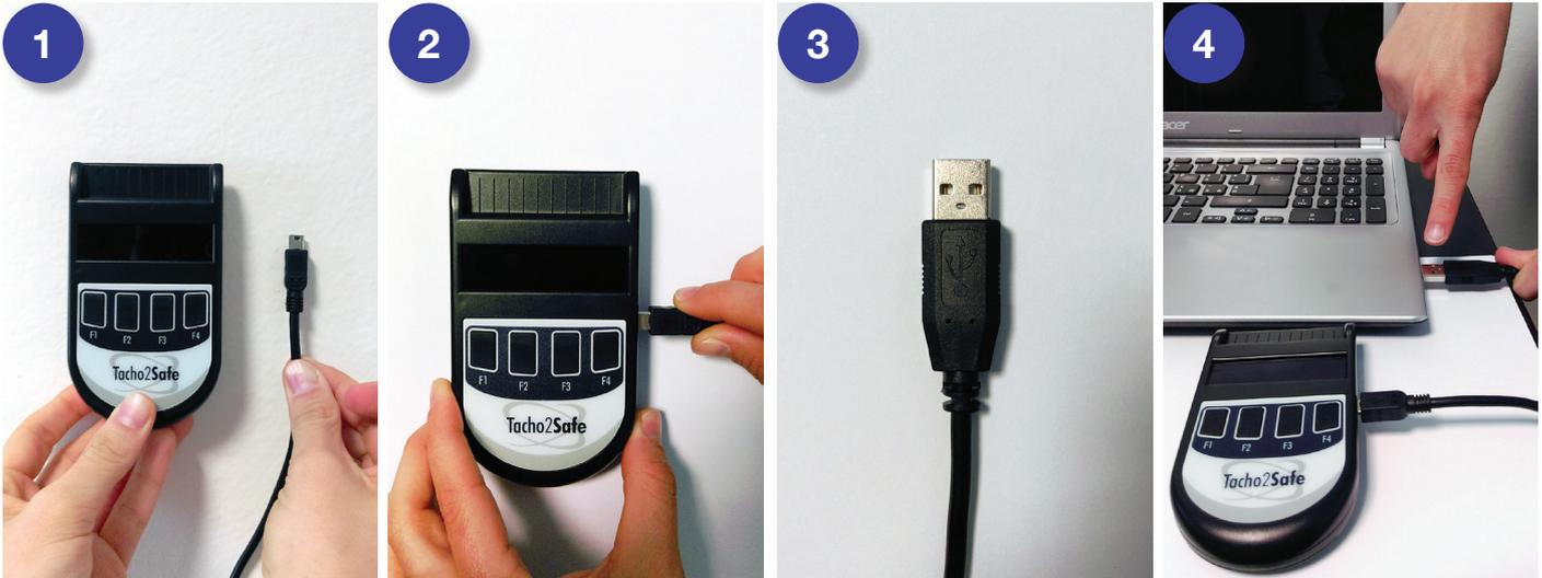
Collegare il cavo USB a lato del dispositivo Tacho2Safe.
