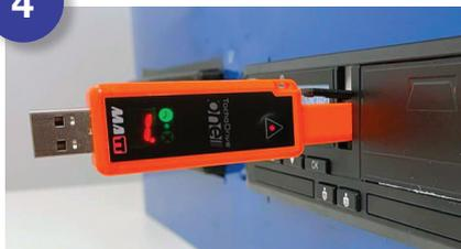
TachoDrive One emetterà un **segnale acustico** e sul display verranno visualizzati i **minuti rimanenti** per completare lo scarico.
