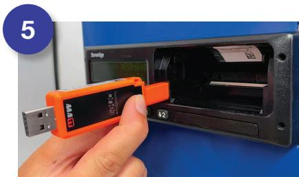
Collegare il TachoDrive One al tachigrafo utilizzando il connettore di scarico, **tenendo premuto il tasto di scarico**.
