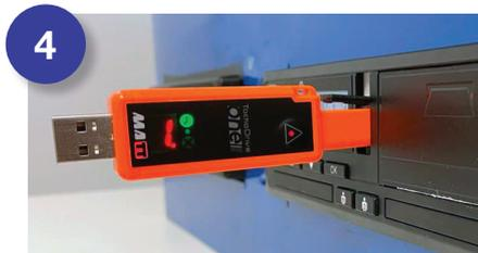
TachoDrive One emetterà un **segnale acustico** e sul display verranno visualizzati i **minuti rimanenti** per completare lo scarico.
