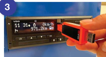
Collegare il TachoDrive One al tachigrafo utilizzando il **connettore di scarico**.
