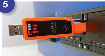
Al termine dello scarico dati TachoDrive One emetterà ripetutamente un **suono acustico** e **sul display appariranno 3 segmenti**, simbolo del completamento dello scarico.
