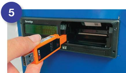
Collegare il TachoDrive One al tachigrafo utilizzando il **connettore di scarico**.
