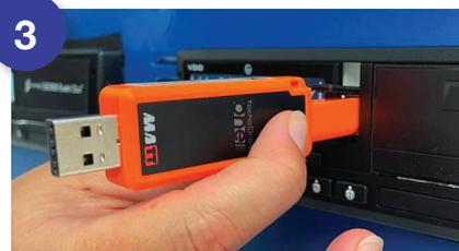
Collegare il TachoDrive One al tachigrafo utilizzando il connettore di scarico, **tenendo premuto il tasto di scarico**.
