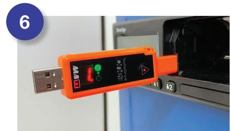
TachoDrive One emetterà un **segnale acustico** e sul display verranno visualizzati i **minuti rimanenti** per completare lo scarico.
