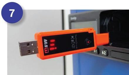
Al termine dello scarico dati TachoDrive One emetterà ripetutamente un **suono acustico** e **sul display appariranno 3 segmenti**, simbolo del completamento dello scarico.
